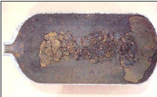
**Grossflächige Korrosion einer Tauchflasche**
